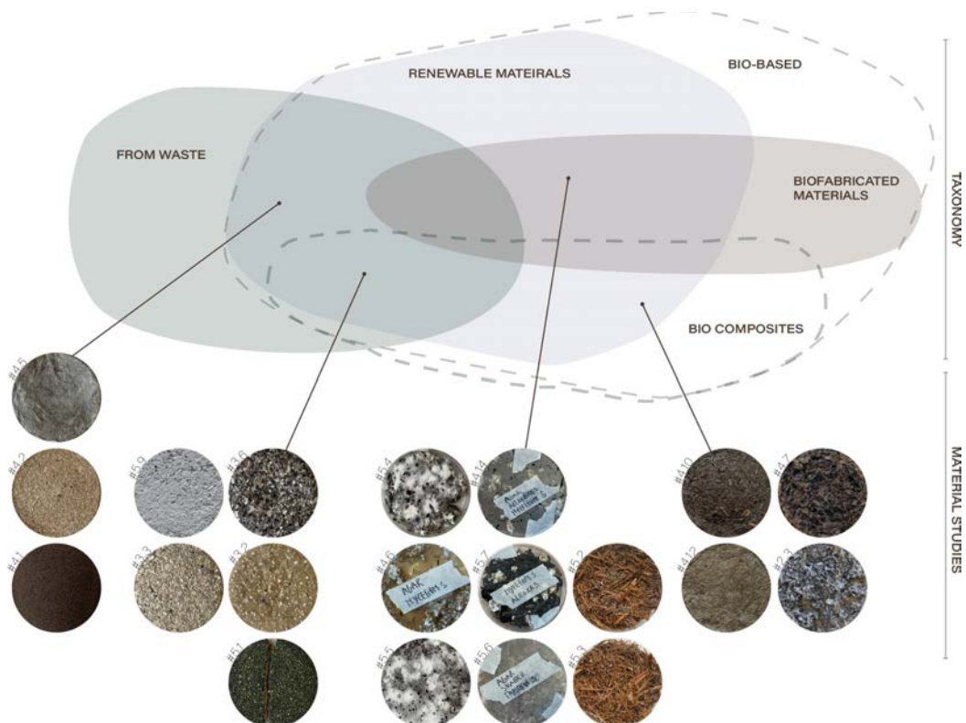
Figure 3: Baseret på Poblete and Rognoli (2024), Emerging Materials for Transition: A Taxonomy Proposal from a Design Perspective . Proposed taxonomy for emerging materials, indeholder figuren et resumé af alle de forskellige undersøgelser, der er foretaget gennem tinkering, step 0. Christensen., P. og Villesen., R. Shaping New Materials . 2024. S. 31.
